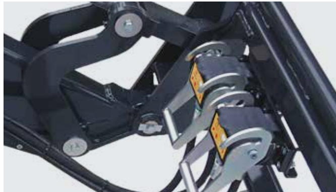
Nástroj Fix 2-násobná spojka pre 3. a 4. riadiaci okruh.
