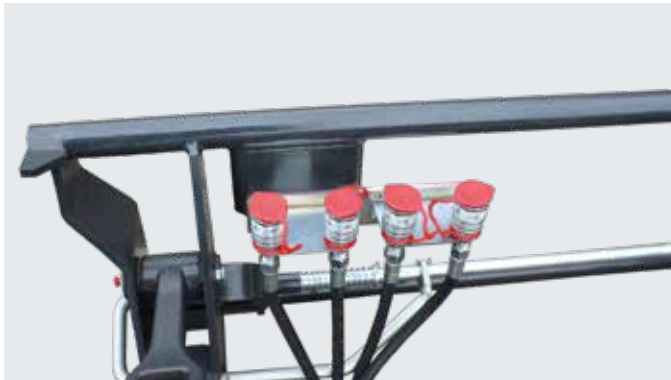
3. a 4. riadiaci okruh (tu ako zásuvná spojka) Pre jednoduchú obsluhu hydraulických nástrojov, napr. silážovacích čelustí, chápadiel na balíky alebo zdvíhacie stohovače balíkov.
